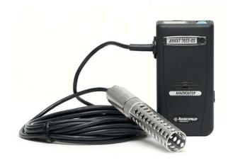
Предназначены для автоматического непрерывного измерения концентрации растворенного кислорода и температуры (только АНКАТ-7655-05) в водной среде. Для измерения концентрации растворенного кислорода при определении биохимического поглощения кислорода БПК природных и сточных вод.
